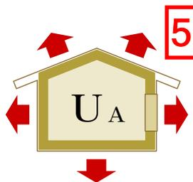
5 外皮平均熱貫流率とは、建物の外壁、屋根、床などを通じて、内外の温度差によって熱が移動する割合を示す指標です。この指標は建物全体の断熱性能を評価するために使われ、断熱性能が高いほど外皮平均熱貫流率は低くなります。
