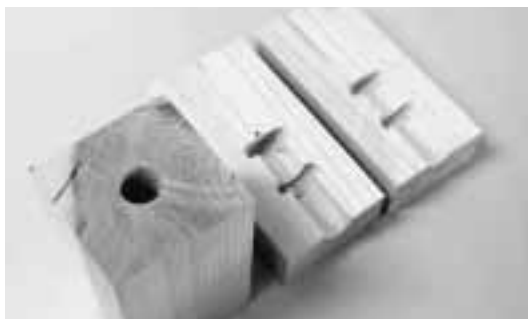
アンカー穴の断面
